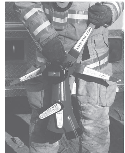
Figure 4.2.3 Les deux ensembles de pieds ouverts et verrouillés en position
