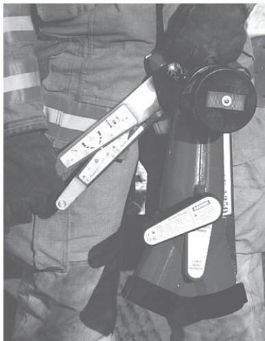
Figure 4.2.1 Tenez la poignée de transport de base et saisissez l'extrémité de l'un des pieds les plus longs
