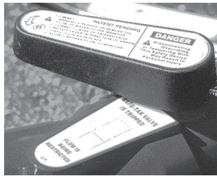
Figure 4.6.1 Soupape de sécurité fermée, débit réduit
